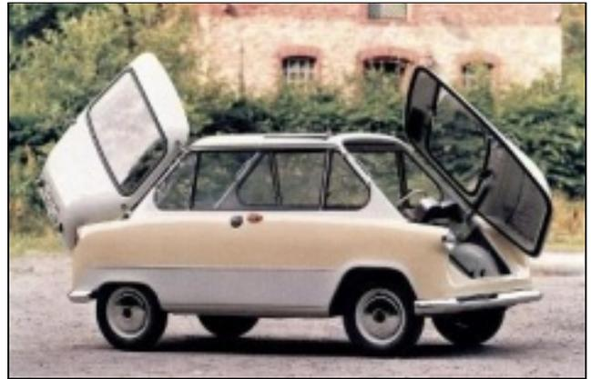
Zwischen den Sitzbänken befand sich der, wie ansonst nur bei Sportwagen vorhandene Mittelmotor mit einem Fallstromvergaser und liegendem Zylinder.
