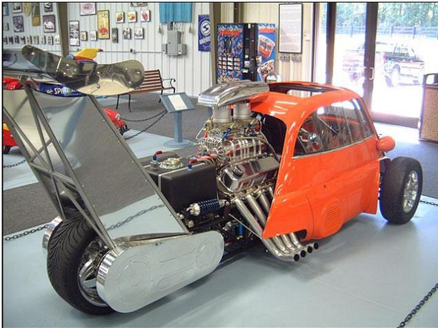
Diese Dragstar-Isetta besitzt einen Big Block Chevy-V8 Motor mit Kompressor (ca. 730hp) und benötigt für Ihren Betrieb Premium 93-Oktan-Kraftstoff. Für die beiden vorderen Felgen wurden BF-Goodrich G-Force P215/60R14 Reifen verwendet, und für den Hinteren ein Sumitoma HTRZ II 285/35ZR18.
