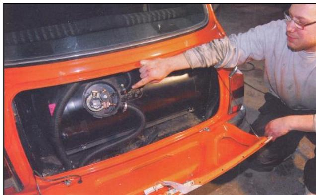
**Besonderheit Mini** - Aus Platzgründen wird der Originaltank völlig entfernt und ein 15-Liter Spritbehälter für den Kaltstart bei niedrigen Temperaturen eingebaut. Dadurch kann der Mini als reines (monovalentes) Gasfahrzeug eingetragen werden und ermöglicht den Erhalt der grünen Umweltplakette. Bei Einspritzern kann der Originaltank erhalten bleiben und erhält so als eingetragenes „bivalentes“ Fahrzeug die grüne Umweltplakette.
