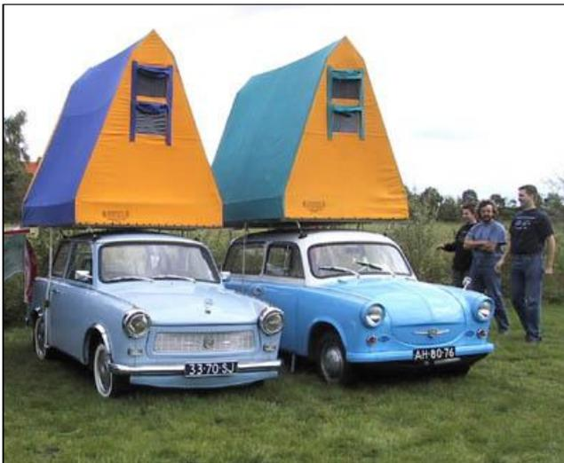
Das Dachzelt bestand aus handelsüblichem Vierkantstahl, einem Boden mit 6 mm starken Spanholzplatten auf dem 10 cm dicke Schaumstoffmatten lagen und bot eine Schlafmöglichkeit für zwei Personen. Die Leinwanddach wurde hingegen als maßgerechte Sonderanfertigung vom VEB Zeltbau Burgstedt produziert.
