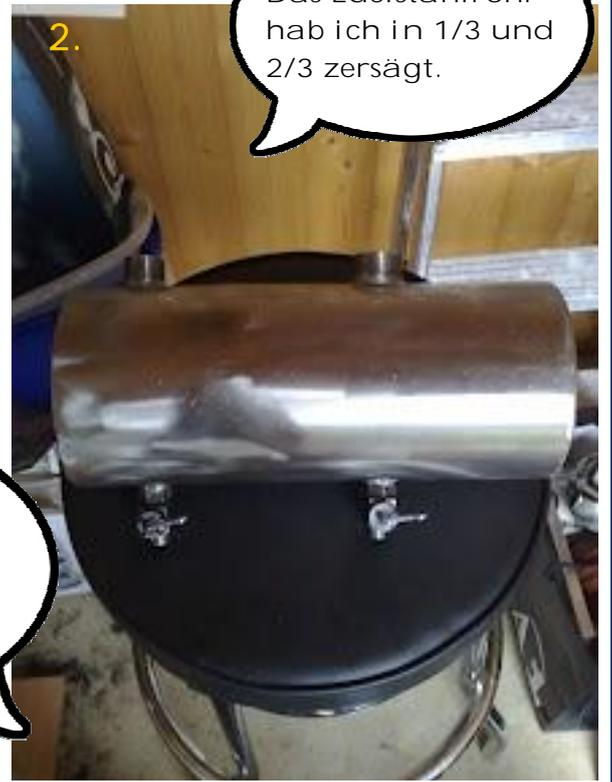
3.) Danach schweißte er ein 1mm Blech ein, um Benzin- und Öl in „einem Tank“ zu haben. Anschließend wurden die Abschlussbleche etwas tiefergezogen um eine Wölbung zu erhalten.
