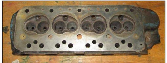
Zylinderkopf Standard, (kein Stegriss, noch nie
