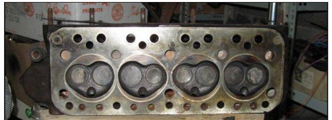
Zylinderkopf 940, 11 Stehbolzen (kein Stegriss)
