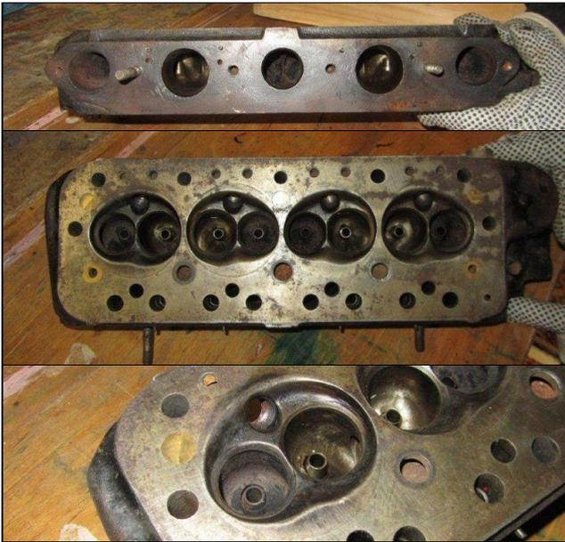
Zylinderkopf Mowog 16783, 9 Stehbolzen
