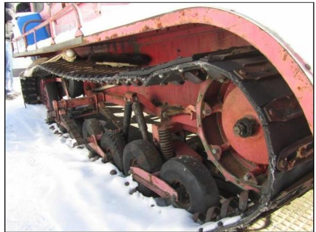
Dieses Kettenfahrzeug wurde zwischen 1957 bis 1981 von der Firma AB Westeras Maskiner (Westeråsmaskiner) gebaut und läuft über zwei Gummiketten, die von einem VW-Boxermotor angetrieben werden.
