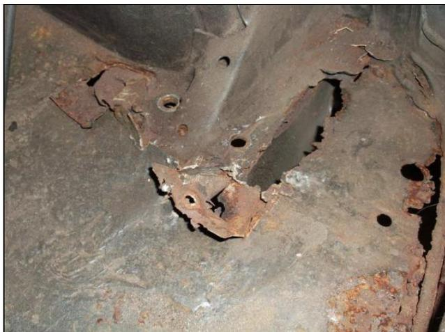
Ein neues Blech für meinen Kofferraumboden war mittlerweile auch eingetroffen und so kam die Flex das erste Mal zum Einsatz. Großzügig trennte Markus mir alle schadhafte Stellen weg, setzte das neue Blech ein, flickte alle anderen Löcher in der näheren Umgebung.
