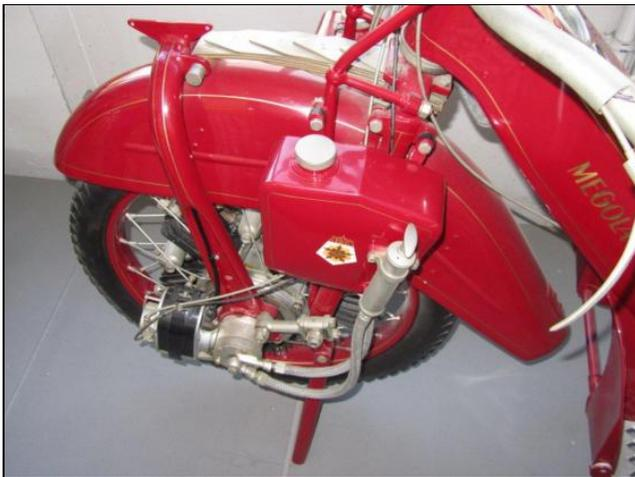
Die niedrige Anordnung des Motors im Vorderrad steigerte Komfort und Fahrstabilität. Der seitengesteuerte, getriebe- und kupplungslose Motor galt als sehr elastisch und schnell (109 km/h).
