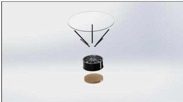
Die Beine wurden aus Rohren mit ca. 25 mm Durchmesser gefertigt und an die Enden jeweils ein Flachstahl geschweißt.
