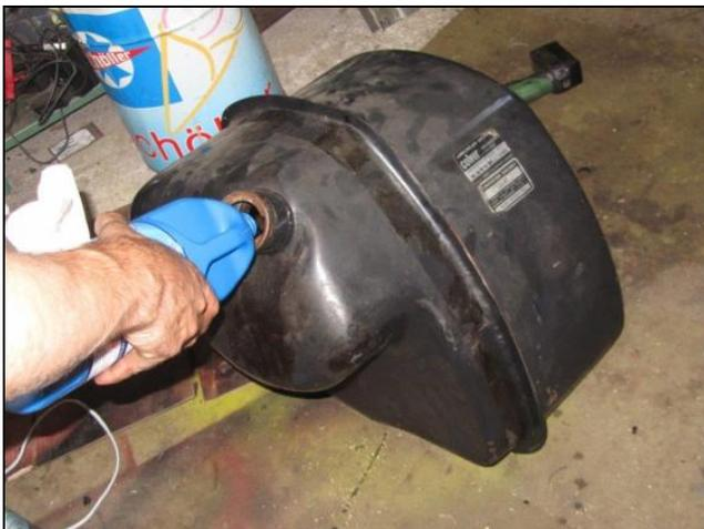
Der Tank soll damit nahezu vollständig gefüllt werden, jedoch nicht bis zur Oberkante, da die Lösung aufschäumt.
