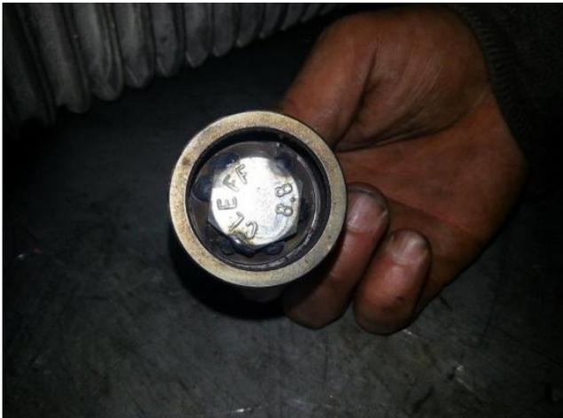
*(Bild oben - Hier sehen wir die bereits verschweißte Schraube mit der Scheibe in der Lagerschale.)*
