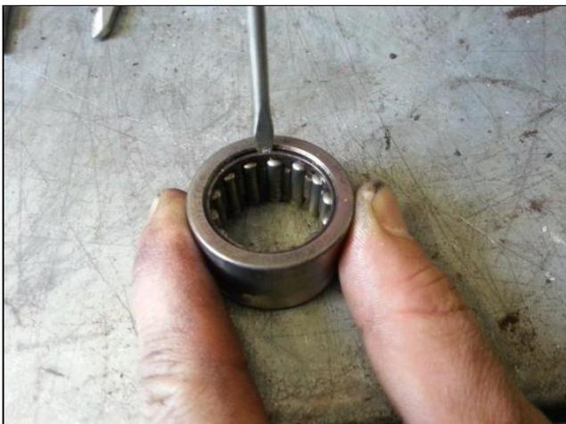
Als nächstes muss die Lagerschale mit dem Stabschleifer so bearbeitet werden, das die Karosseriescheibe exakt in die Lagerschale hineinpasst. Dafür sollte nur an zwei Stellen eine Erweiterung eingefräst werden!
