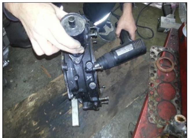
Während des Erwärms, immer wieder mit einem passendem Gabelschlüssel die M12 Mutter fester ziehen.
