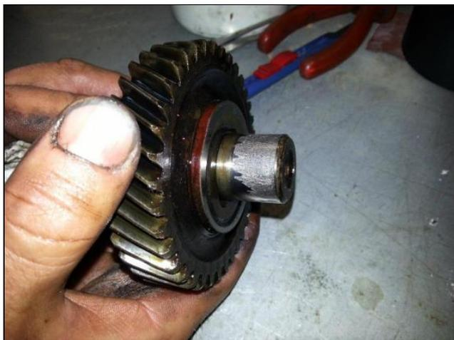
(Bild oben - Angeriebener Lagerzapfen vom Zwischenrad, das durch zuviel Spiel entstanden ist).
