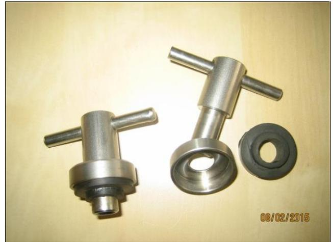
Da Alu-Deckel und Stahldeckel etwas unterschiedlich gefertigt sind, was sich in der Höhe der Schrauben bemerkbar macht, haben wir auch unterschiedliche Längen gefertigt, damit der Zwischenring nicht mehr nötig ist.
