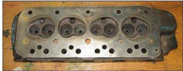
Zylinderkopf Standard, (kein Stegriss, noch nie
