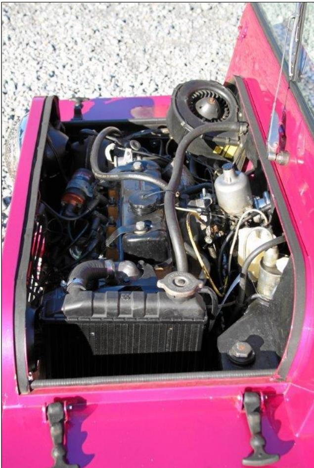
Zu guter Letzt musste aus Platzmangel auf einen Luftfilter verzichtet werden. Direkt neben dem kurzen, offenen Lufteinlass des Vergasers, der bereits im rückwärtigen Instrumentengehäuse endet, verläuft die Tachowelle zum Mitteltacho.
