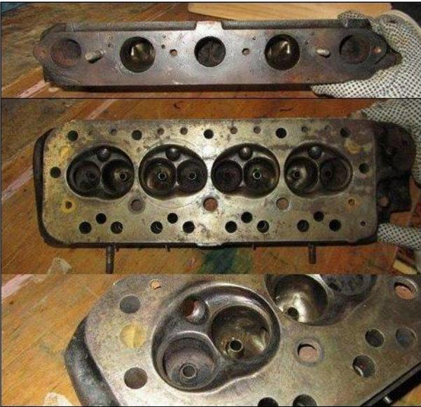
Zylinderkopf Mowog 16783, 9 Stehbolzen
